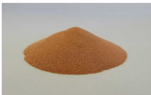
<参考：表面処理を施した 3D プリンター用純銅粉>
