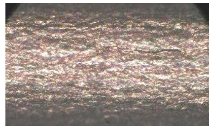
写真1 NKT322 の W 曲げ凸面の光学顕微鏡写真( Badway, R/t = 1) 質別:SH , 板厚:0.1mm(TS=1.05GPa) 質別:SH , 板厚 0.08mm(TS=1.03GPa)
