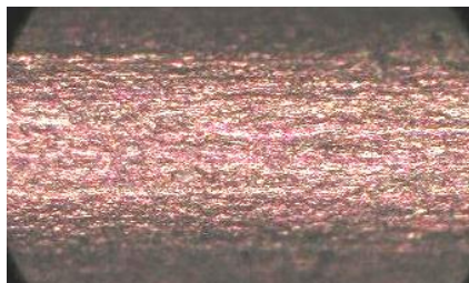
写真1 NKT322 の W 曲げ凸面の光学顕微鏡写真( Badway, R/t = 1) 質別:SH , 板厚:0.1mm(TS=1.05GPa) 質別:SH , 板厚 0.08mm(TS=1.03GPa)
