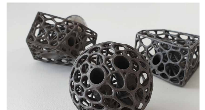
金属3Dプリンターで設計・造形された足首用のインプラント(人工骨)
