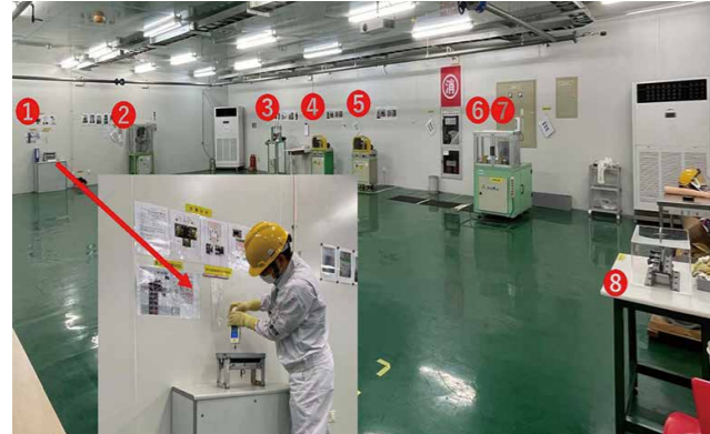
危険体感教育設備(安全靴の踏抜き体感の例)(日鉱金属(蘇州)有限公司)
