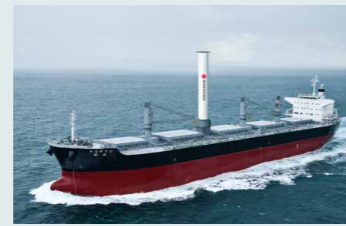
ローターセイル設置後の鉱船KORYU マグナス効果のイメージ
